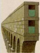
Querschnitt durch einen römischen Aquädukt.
